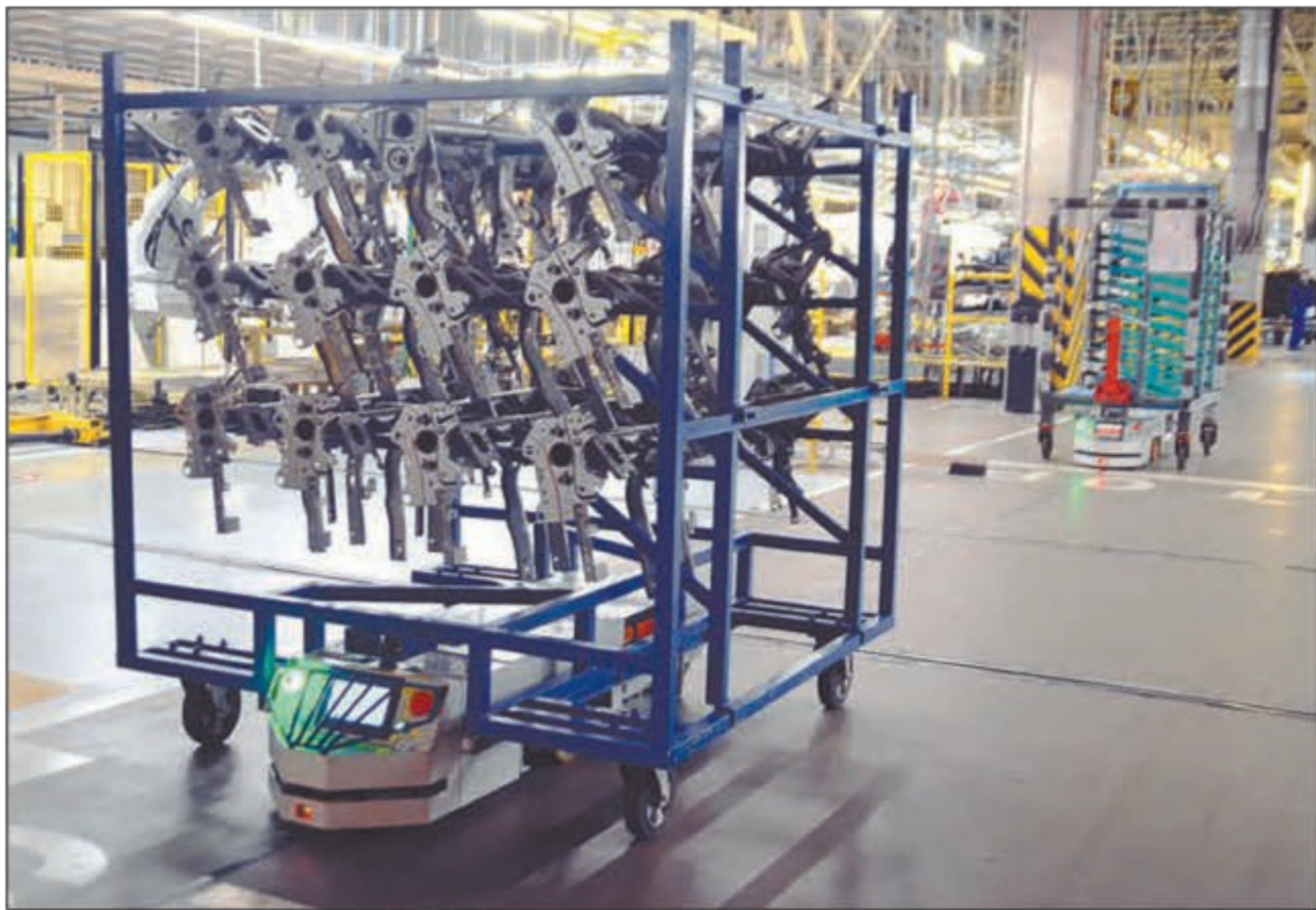
В цехах петербургского автозавода роботизированные тележки самостоятельно развозят необходимые компоненты к местам назначения, передвигаясь по закрепленным на полу магнитным лентам.
